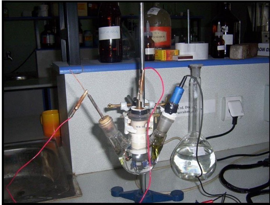
Şekil 3.4. Korozyon hücresinin fotoğrafı
