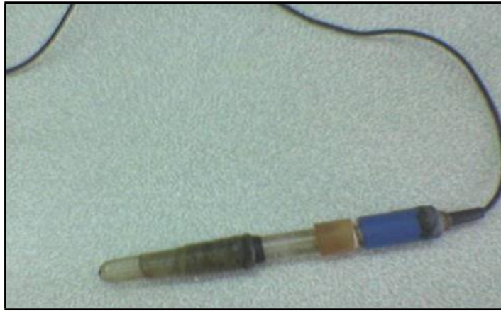
Şekil 3.5. Deneyde kullanılan Doymun Kalomel Elektrot (DKE)
