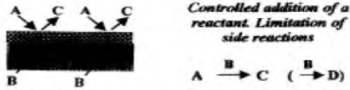
Resim 2.17. Distribütör konfigürasyonunun şematik olarak gösterimi. -active contactor: Reaktan(ların) kontrol edilerek katalizöre difüzyonu mühendislik açısından gelişmiş katalitik bölgenin oluşmasını sağlamaktadır.
