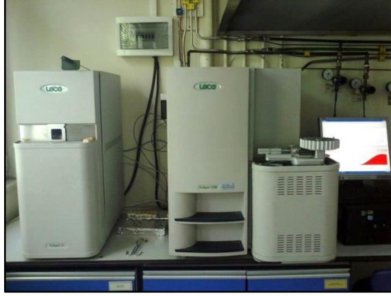
Resim 3.2. LECO Truspec CHN-S elementel analiz cihazı
