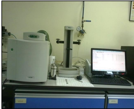
Resim 3.1. LECO TGA 701 termogravimetrik analiz cihazı
