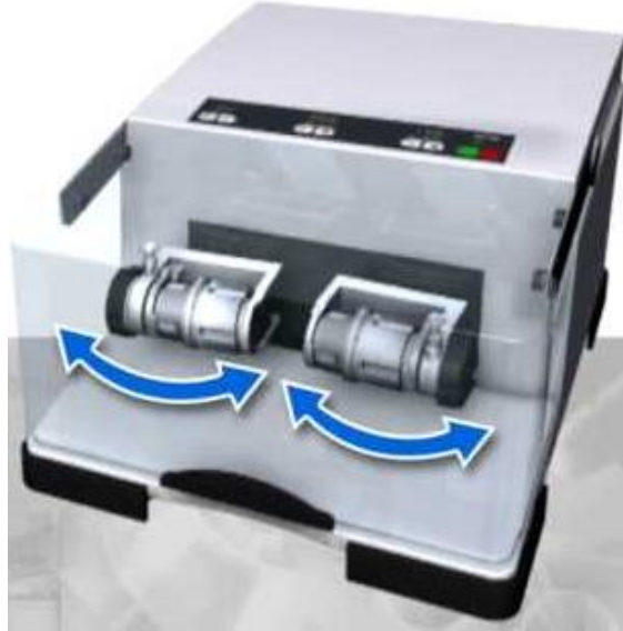
Bilyalı değirmen çalkalayıcı motor ünitesi
