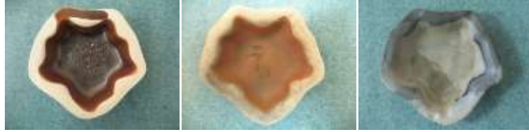
Resim 59: ESC-1 Döküm Çamuru - %55 Sülyen – Ladik Kili (L-55)-%1 Bakır Oksit
