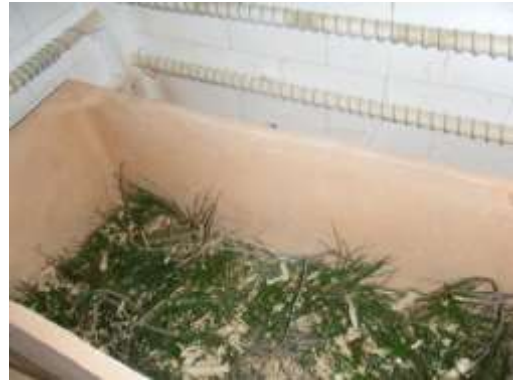
Şekil 4. : Sagar Kutularının Pişirim İçin Hazırlanması
