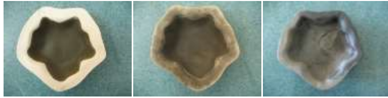
Resim 46: ESC-1 Döküm Çamuru - %40 Sülyen – Karatay Kili (K-40)-%3 Kobalt Oksit
