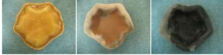
Resim 29: ESC-1 Döküm Çamuru - %30 Boraks – Karatay Kili (K-30)
