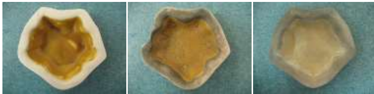
Resim 23: ESC-1 Döküm Çamuru - %55 Sülyen – Karatay Kili(K-55)
