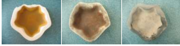
Resim 43: ESC-1 Döküm Çamuru - %40 Sülyen – Karatay Kili (K-40)-%1 Kırmızı Demir Oksit
