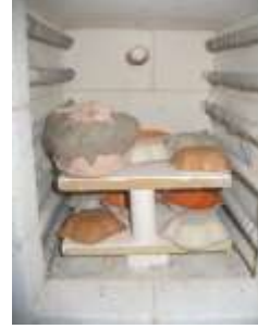
Resim 16: Uygulanan astarların fırınlanması
