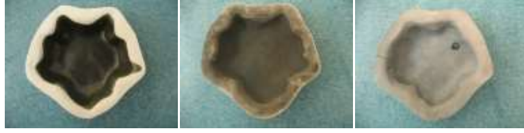
Resim 36: ESC-1 Döküm Çamuru - %40 Sülyen – Kampus Kili (A-40)-%3 Kobalt Oksit
