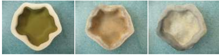
Resim 51: ESC-1 Döküm Çamuru - %40 Sülyen – Karatay Kili (K-40)-%1 Krom Oksit
