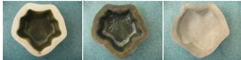
Resim 35: ESC-1 Döküm Çamuru - %40 Sülyen – Kampus Kili (A-40)-%1 Kobalt Oksit
