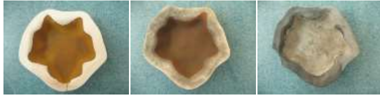
Resim 44: ESC-1 Döküm Çamuru - %40 Sülyen – Karatay Kili (K-40)- %3 Kırmızı Demir Oksit
