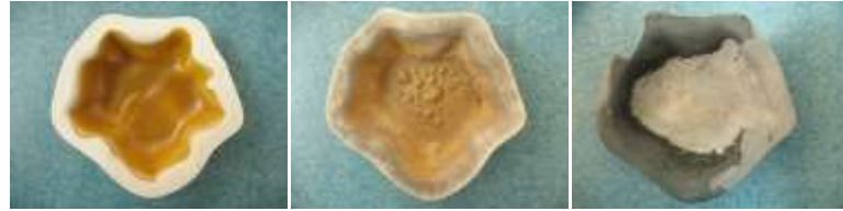
Resim 33: ESC-1 Döküm Çamuru - %40 Sülyen – Kampus Kili (A-40)- %1 Kırmızı Demir Oksit
