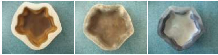
Resim 47: ESC-1 Döküm Çamuru - %40 Sülyen – Karatay Kili (K-40) %1 Mangan Oksit
