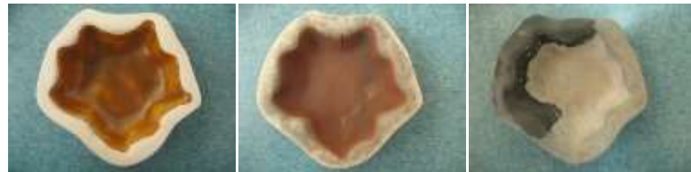
Resim 34: ESC-1 Döküm Çamuru - %40 Sülyen – Kampus Kili (A-40)- %3 Kırmızı Demir Oksit
