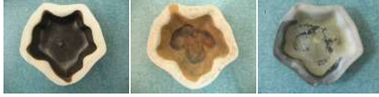
Resim 62: ESC-1 Döküm Çamuru - %55 Sülyen – Ladik Kili (L-55)-%3 Krom Oksit
