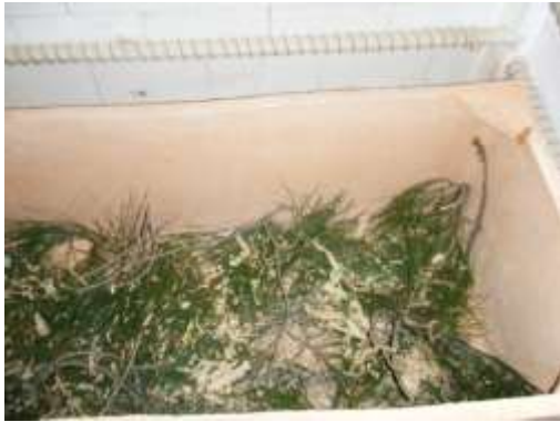
Şekil 4. : Sagar Kutularının Pişirim İçin Hazırlanması
