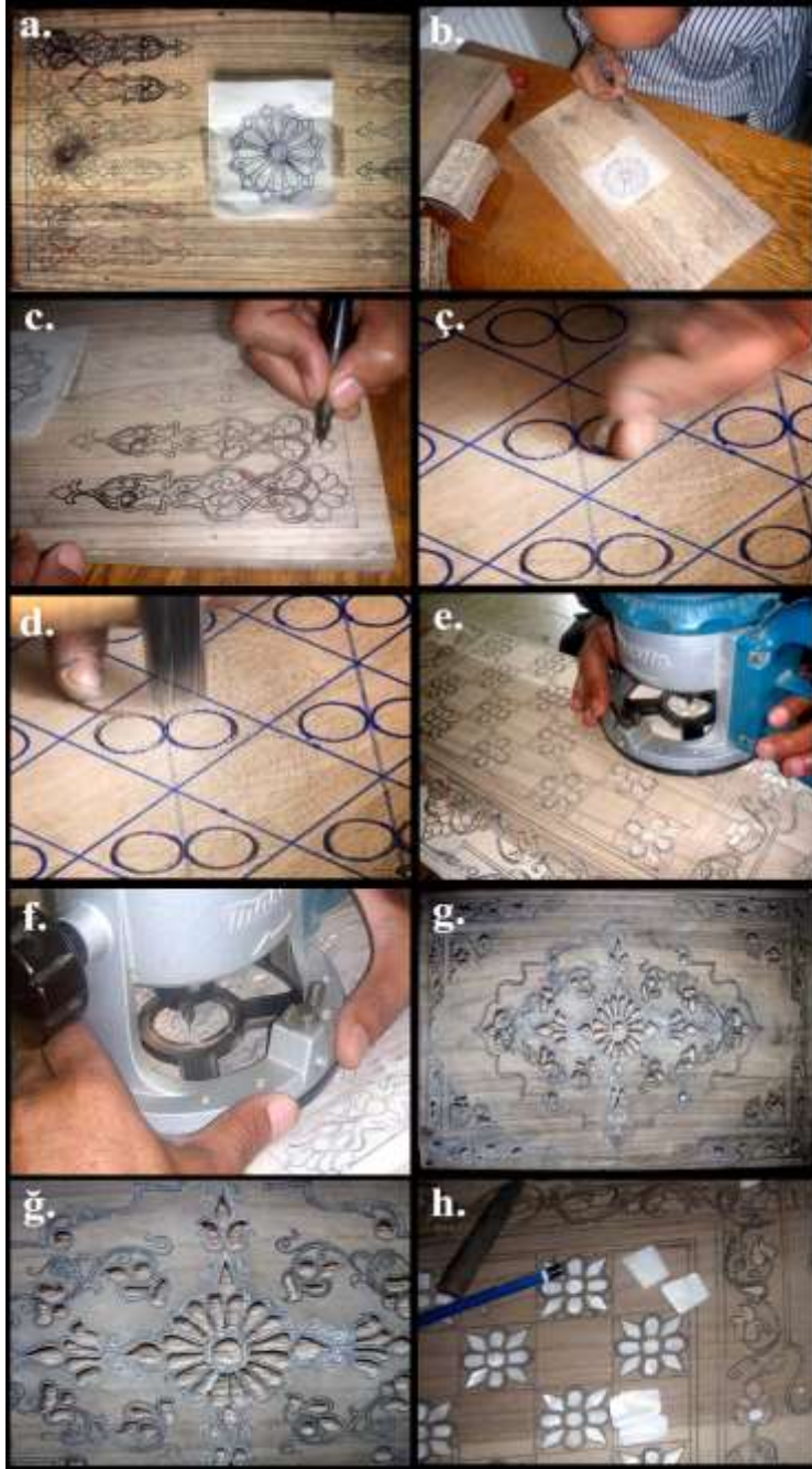
Şekil 6. Sedef Kakmacılığının Yapım Aşamaları; a. Aydınır Kâğıdı İle Desenin Aktarılması, b. Desenin Çizilmesi, c. Desenin Asetat Kalem İle Belirginleştirilmesi, ç. Motiflerin Etrafına Yuvaların Açılması, d. Açılan Yuvalara Telin Yerleştirilmesi, e. Sedeflerin Yuvalarının Oyulması, f. Sedeflerin Yuvalarının Oyulması, g. Sedef Yuvaları Oyulmuş Ahşap, ğ. Ayrıntı, h. Sedeflerin Yuvalarına Uygun Biçimde Kesilmesi (ç,d Anonim 2011, diğerleri Aktürk 2012)
