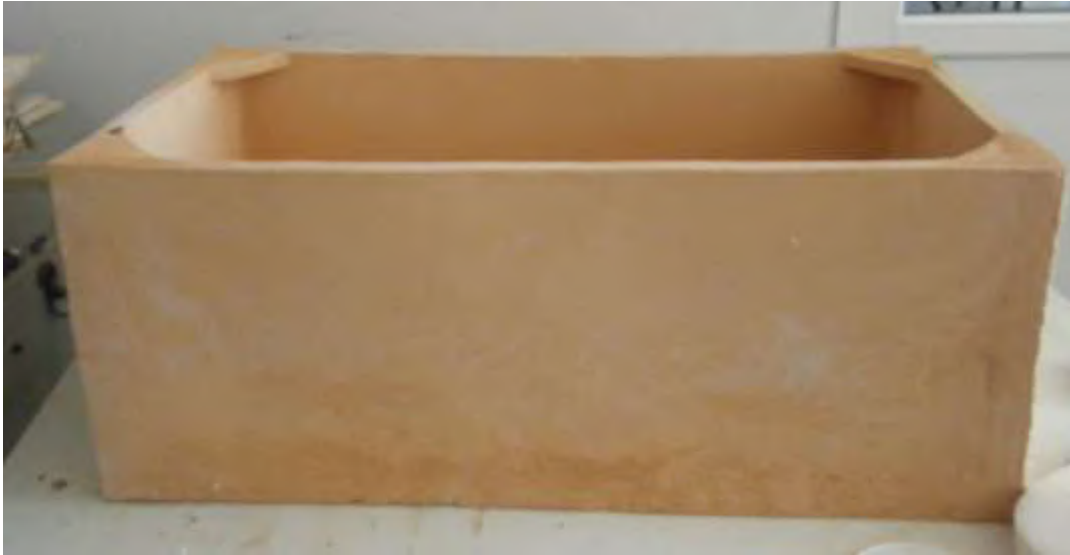
Şekil 3. : Yapımı Tamamlanan Sagar Kutusu
