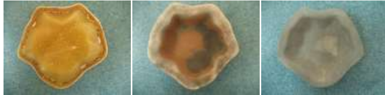
Resim 31: ESC-1 Döküm Çamuru - %30 Boraks – Kampus Kili (A-30)
