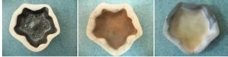
Resim 58: ESC-1 Döküm Çamuru - %55 Sülyen – Ladik Kili (L-55)-%3 Mangan Oksit
