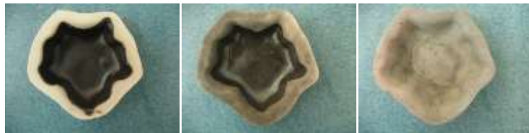
Resim 41: ESC-1 Döküm Çamuru - %40 Sülyen – Kampus Kili (A-40)-%1 Krom Oksit
