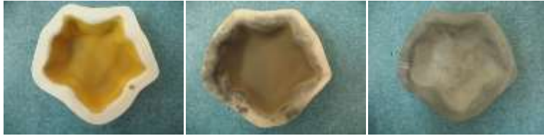
Resim 22: ESC-1 Döküm Çamuru - %40 Sülyen – Karatay Kili(K-40)
