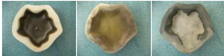
Resim 41: ESC-1 Döküm Çamuru - %40 Sülyen – Kampus Kili (A-40)-%1 Krom Oksit
