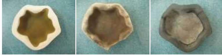
Resim 45: ESC-1 Döküm Çamuru - %40 Sülyen – Karatay Kili (K-40)-%1 Kobalt Oksit
