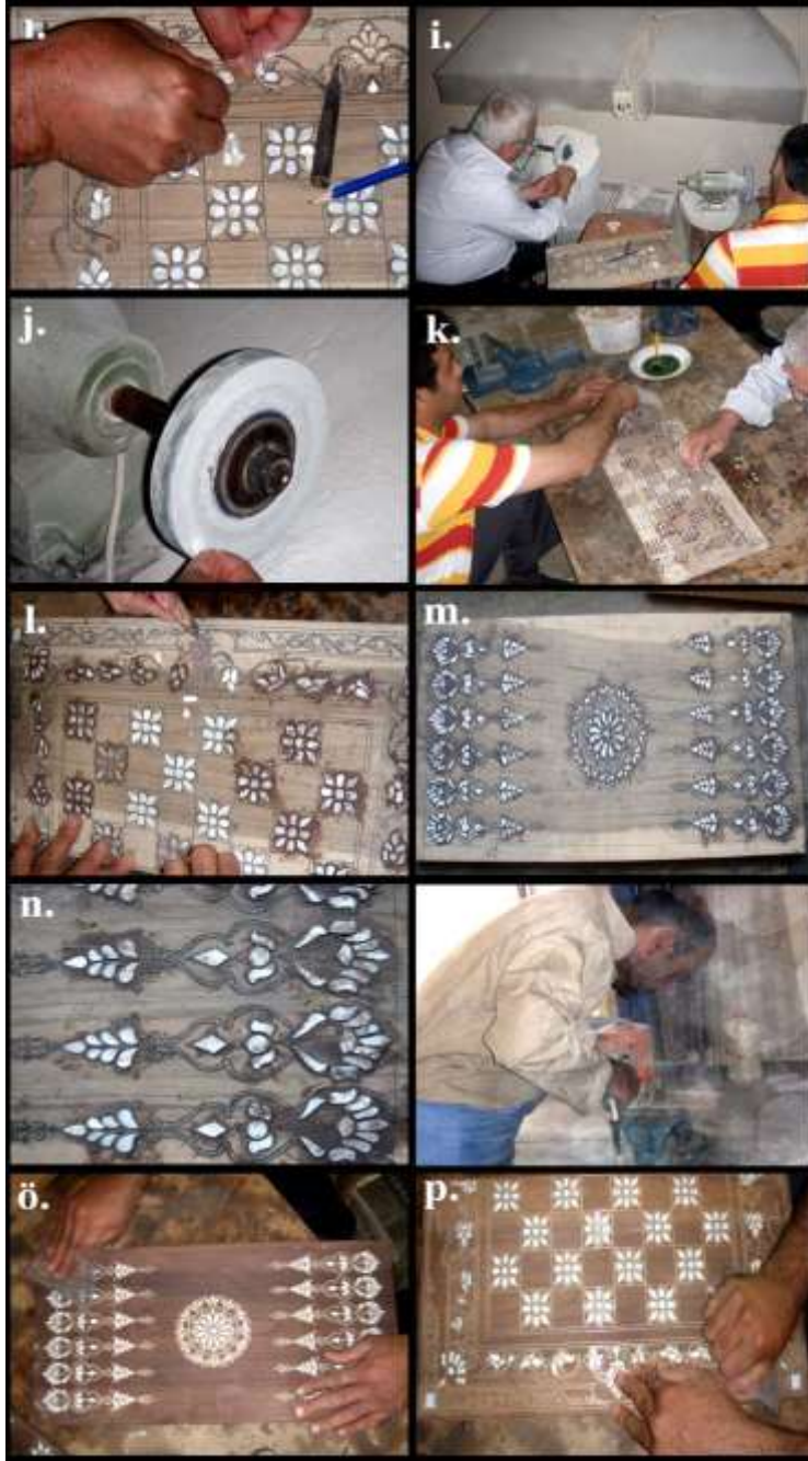
Şekil 7. Sedef Kakmacılığının Yapım Aşamaları; ı. Sedeflerinin Yuvalarına Uygun Biçimde Kesilmesi, i. Taş Motoru ile Sedeflerin Şekillendirilmesi, j. Ayrıntı, k. Macun ile Sedeflerin Yuvalarına Yerleştirilmesi, l. Ayrıntı, m. Sedeflerinin Tamamı Macun ile Yerleştirilmiş Ürün, n. Ayrıntı, o. Zımpara İşlemi, ö. El ile Zımparalama, p. Diğer Tarafında El ile Zımparalanması (Aktürk 2012)
