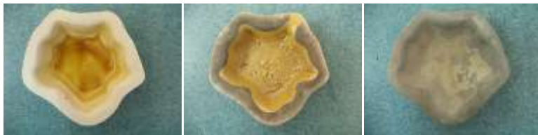
Resim 24: ESC-1 Döküm Çamuru - %40 Sülyen – Kampus Kili(A-40)
