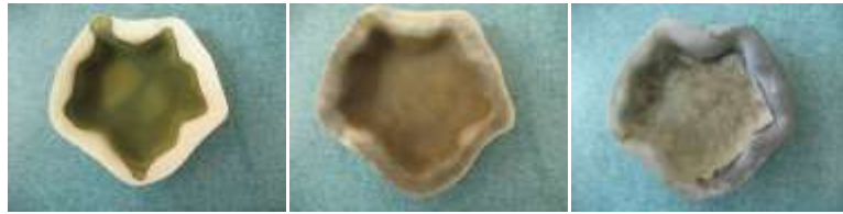
Resim 52: ESC-1 Döküm Çamuru - %40 Sülyen – Karatay Kili (K-40)-%3 Krom Oksit
