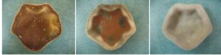
Resim 30: ESC-1 Döküm Çamuru - %35 Boraks – Karatay Kili (K-35)
