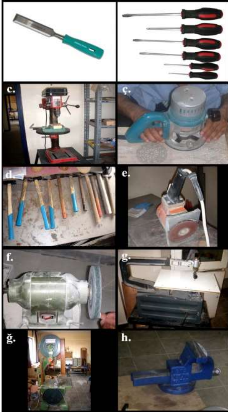
Şekil 1. Sedef Kakmacılıkta Kullanılan Araçlar; a. İskarpile, b. Tornavidalar, c. Matkap, ç. Freze Makinesi, d. Çekiçler, e. Zımpara Makinesi, f. Taş Motoru, g. Kıl Testere, ğ. Hızır, h. Mengene (Aktürk 2012)
