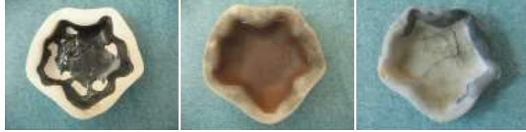
Resim 57: ESC-1 Döküm Çamuru - %55 Sülyen – Ladik Kili (L-55)-%1 Mangan Oksit
