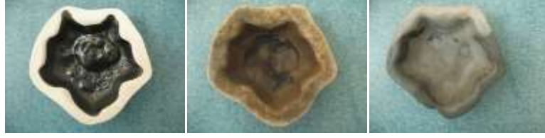
Resim 56: ESC-1 Döküm Çamuru - %55 Sülyen – Ladik Kili (L-55)-%3 Kobalt Oksit
