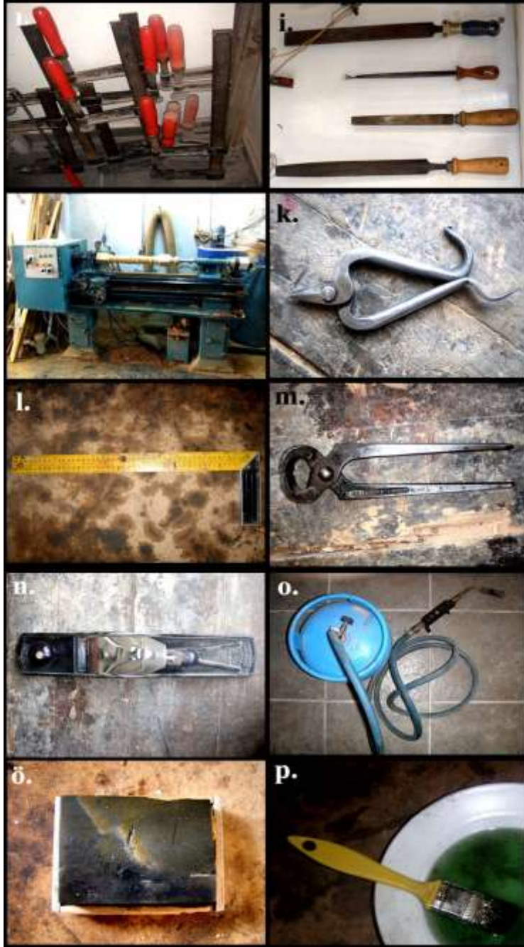
Şekil 2. Sedef Kakmacılıhta Kullanılan Araçlar; 1. İşkenceler, i. Eğeler, j. Torna Makinesi, k. Çelik Makası, l. Gönye, m. Kerpeten, n. Rende, o. Pürmüz, ö. Bileği Taşı, p. Fırça (Aktürk 2012)
