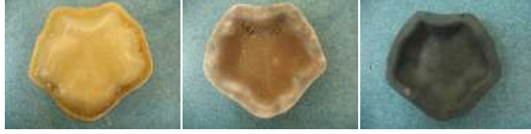
Resim 32: ESC-1 Döküm Çamuru - %35 Boraks – Kampus Kili (A-35)
