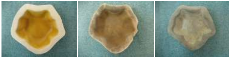
Resim 24: ESC-1 Döküm Çamuru - %40 Sülyen – Kampus Kili(A-40)
